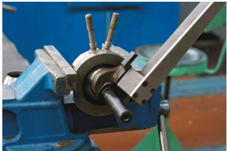
Рис. 2. Вид установки для испытаний запорного элемента (шара)
